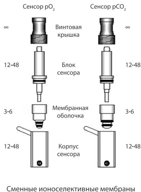
Долговечные и надежные ионоселективные электроды для определения электролитов и газов крови. Точность измерения и долговечность блоков являются отличительными признаками сенсоров. Низкая стоимость эксплуатации и сменные мембраны позволяют сократить расходы на обслуживание.
