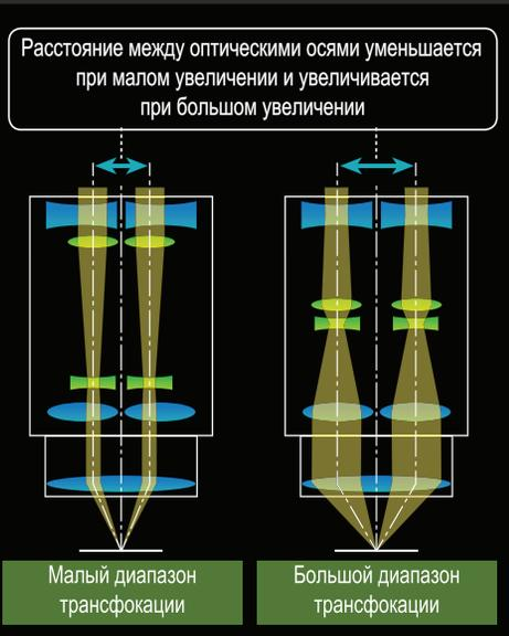
Более высокое значение числовой апертуры для обоих каналов в сочетании с превосходным коэффициентом трансфокации обеспечивает плавный просмотр на макро-и микроуровне.
