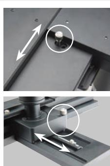
Регулировка столика с использованием XY-шифта (три диапазона)
