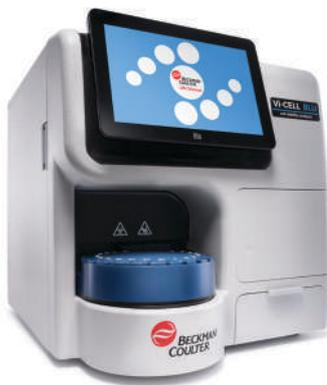
Vi-CELL BLU автоматизирует широко используемый метод оценки жизнеспособности клеток по вытеснению ими красителя трипанового синего. Этот метод традиционно выполнялся с помощью светового микроскопа, пипетки и камеры Горяева. Автоматизация анализа делает прибор идеальным для оценки количества и жизнеспособности как крупных, так и мелких клеток во многих областях, включая биофармакологию и научные исследования.
