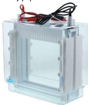
Стекла со вклейными стеклянными спейсерами, дополнительные спейсеры, заливочное устройство и гребенки различной толщины и разным количеством зубцов.
