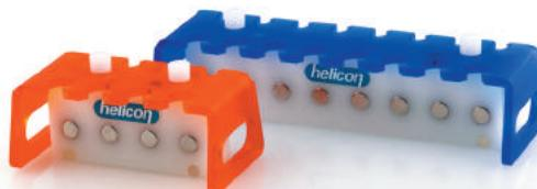
Штативы серии «Полюс», разработанные для одиночных пробирок, состоят из двух частей: верхнего съемного штатива-держателя пробирок и самого магнита, благодаря чему можно переносить пробирки на штативе отдельно от магнита. Магнитные штативы «Полюс» вмещают от 8 до 16 пробирок объемом 0,5 и 1,5 мл.
